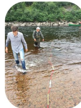
Site # 1 - Installation du fil calculant les vibrations du fond de la rivière
